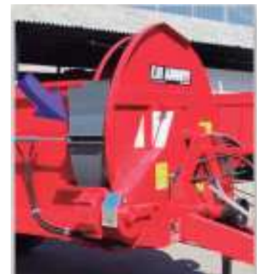
PUERTA LATERAL HIDRÁULICA.
