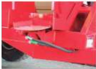
DISCO LATERAL PARA LOCALIZAR ESTIÉRCOL EN LA HILERA HIDRÁULICO CON INCLINACIÓN MANUAL
