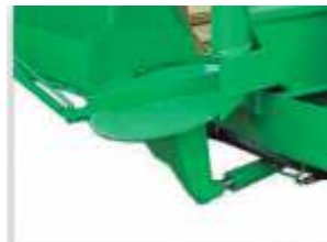
INCLINACIÓN HIDRÁULICA PARA DISCO HIDRÁULICO LATERAL POR CILINDRO
